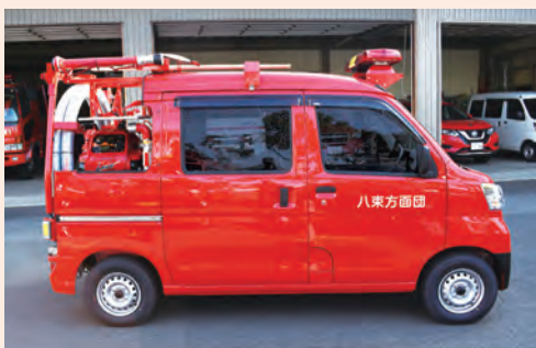
■ こ が た どう り ょく つ き せ き さい しゃ 小型動力ポンプ付積載車
