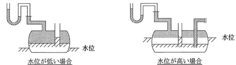
図1 微加圧法の点検範囲例 ( ■ 点検範囲)
