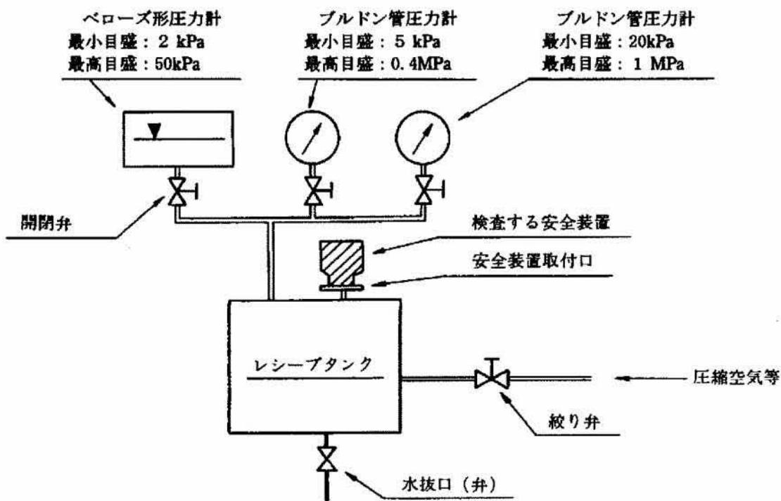
例2 最高試験圧力0.4MPaの試験装置
