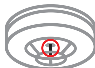
温度を感知する 電子部品 (サーミスタ)
