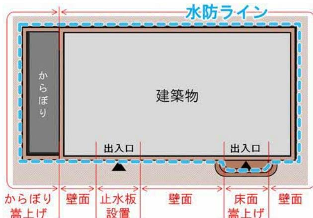
建築物の周囲に水防ラインを設定し、水防ラインに沿って切れ目なく浸水対策を講じることにより、水防ライン外からの浸水を防ぐことができる。開口部はマウンドアップ及び止水板（陸閘（りっこう。堤防の役割を果たす開閉可能な門扉で、個人住宅では塀の開口部における防水性の門扉）とも呼ばれる。）の設置により浸水防止を図ることができる。
