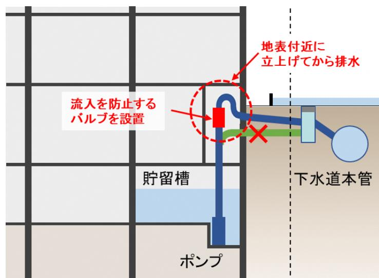
下図は、停電等によりポンプが停止した際に、逆止弁等のバルブが有効に作用しない場合の排水設備を通じた下水道からの逆流防止対策として、より望ましい配管方式を模式的に示したものである。
