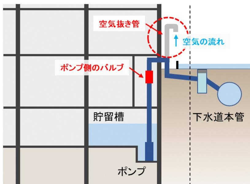
(臭気対策として空気抜き管の頂部に通気弁を設けた例)
