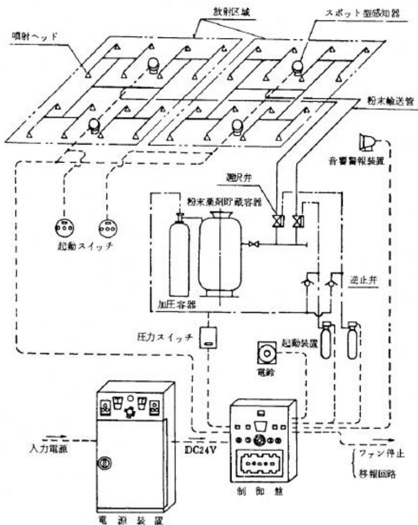
図8-2 粉末消火設備粉末容器附属機器圖例
