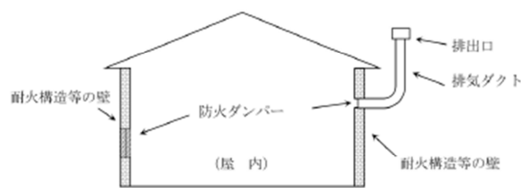
防火ダンパーの設置例
