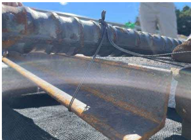
検証②結束状況（隙間2mm）
