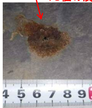
18個の腐食孔の一例
