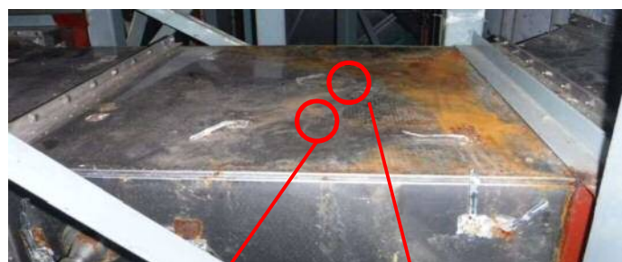
18個の腐食孔の一例
