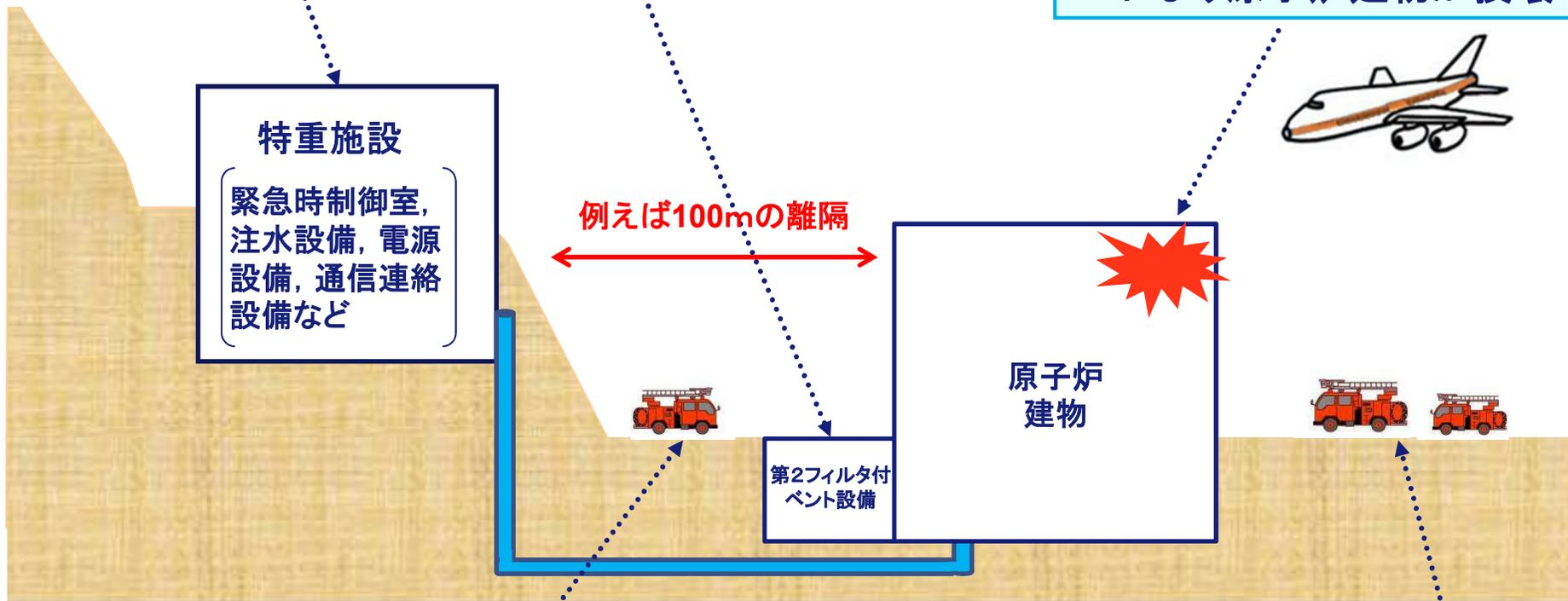
② 送水車等の可搬型設備(重大事故等対処設備)にて原子炉格納容器を冷却
