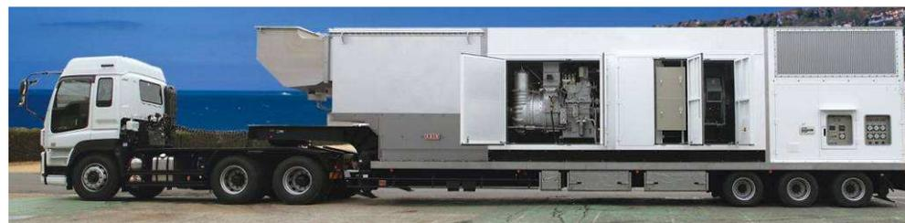
電源の強化のため、ガスタービン発電機車を配備
