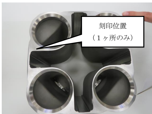
金具に示された刻印（型式表示）の位置
