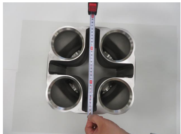
燃料支持金具の穴径（上側）と奥行幅
