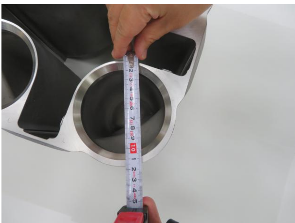
燃料支持金具の穴径（上側）と奥行幅
