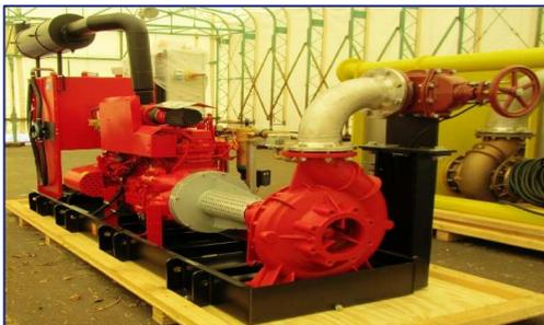
当該ポンプで海水を熱交換器に供給することにより、万一、原子炉補機海水ポンプがすべて使えなくなった場合でも、原子炉を冷やすことが可能。
