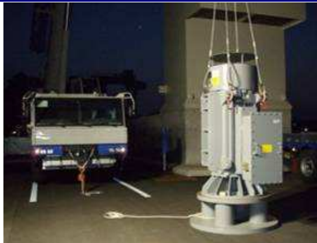
▲敷地内に配備した原子炉補機海水ポンプ電動機の子備品
