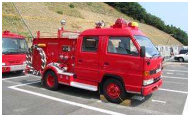
▲代替注水を行うための消防ポンプ車を配備。 今後さらに追加配備する
