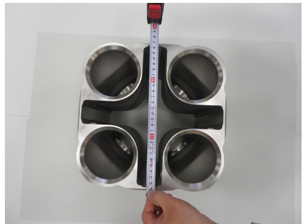
燃料支持金具の穴径（上側）と奥行幅
