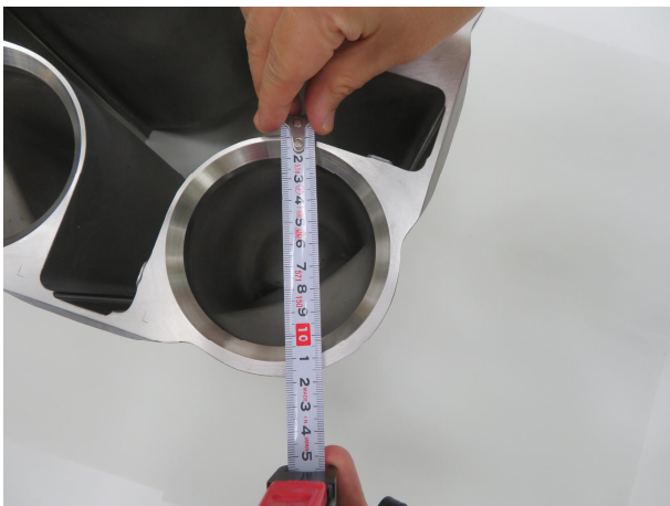
燃料支持金具の穴径（上側）と奥行幅
