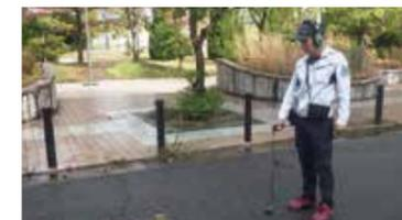
漏水探知機を使用し、地下の水道管からの漏水音を聞き取り、漏水箇所を特定する仕事です。
