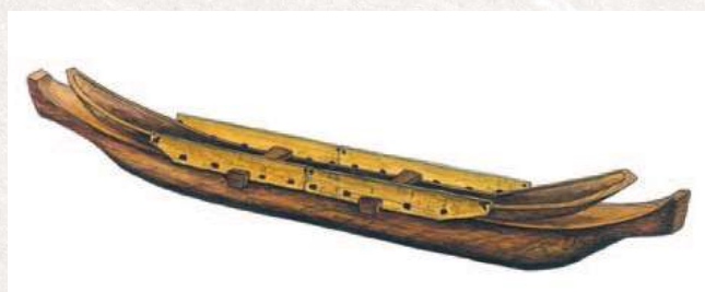
弥生時代の舟（準構造船）の復元図 （鹿島町稗田遺跡出土舟材をもとに復元）
