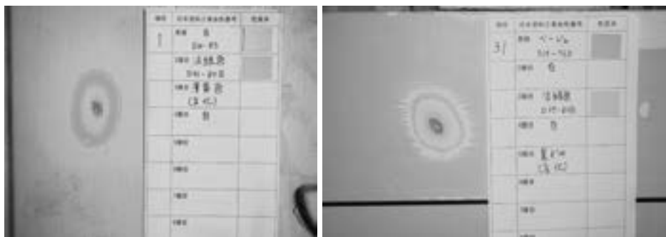
写真3-3-22 塗膜各層の様子
