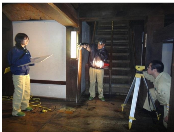
現地調査（不陸・傾斜調査）
