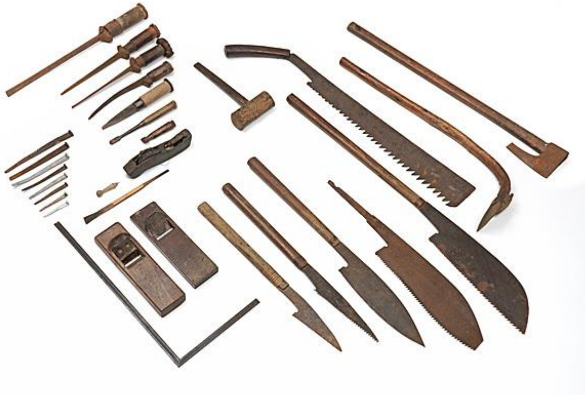
【写真 3】椿油で防錆処理した舟大工用具(央道湖の漁撈用具)
