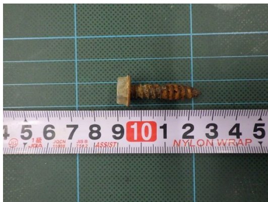
脱落したネジ
