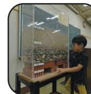
ダムに溜まった水は管を通して浄水場にやってきます。ここできれいな水になるんだね。まずは水の中のばい菌や汚れを固めるための薬を入れてかき混ぜるよ。そうすると、汚れが固まりになって見えてきた。この固まりが底に沈んで、濁りのない水にしてから、砂→砂利→石の順にゆっくり水を通して、び生物の働きで飲める水にしていくんだ(緩速(かんそく)ろ過(ろか))。これでやっと井戸水と同じような状態。ここに消毒薬を入れて、安全な水道水になる。
