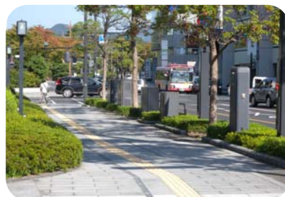
(大手前通り) 照明柱、時刻表、送電用地上機器等を車道側に集め、歩行空間をすっきりさせている。
