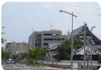
ポール灯(駅通り) 信号機と道路照明のポールを共用することでポールの乱立を防いでいる。
