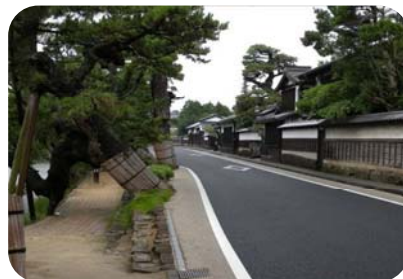
土系舗装/薄層カラー舗装(塩見縄手) 歴史的な町並みに調和した道路。車道、路側帯、歩道の素材や色彩に配慮している。
