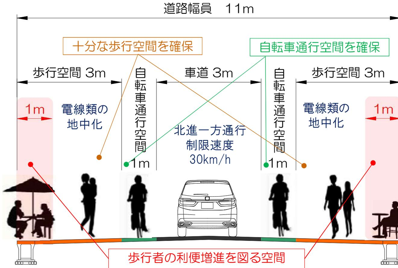
歩道と車道は段差のない構造または高さ2cmの縁石で分け、歩道と車道を分けるための車止めなどを所々に設置
