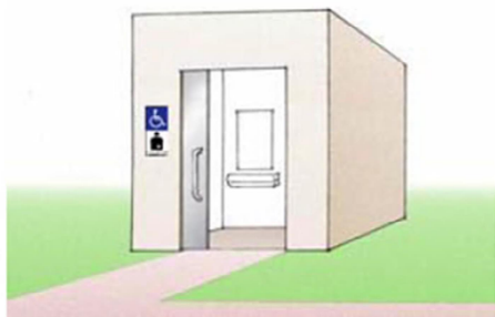
図1 ケース1「みんなのトイレ」を独立して設置したトイレ
