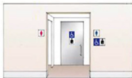
図2 ケース2 1つの便所内に「みんなのトイレ」のスペースを設置したトイレ
